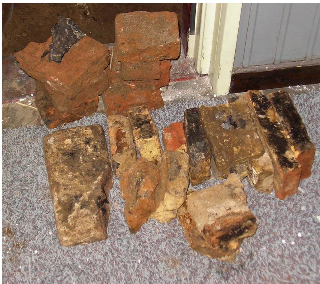
Eenzijdig zwartgeblakerde stenen die zijn hergebruikt in de fundering. Foto 2007
